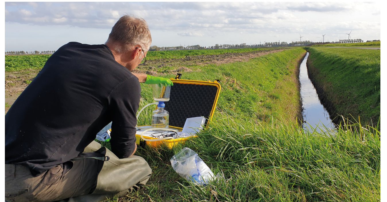
Figuur 3. Met een vacuümpomp wordt het watersample door een filter getrokken.
