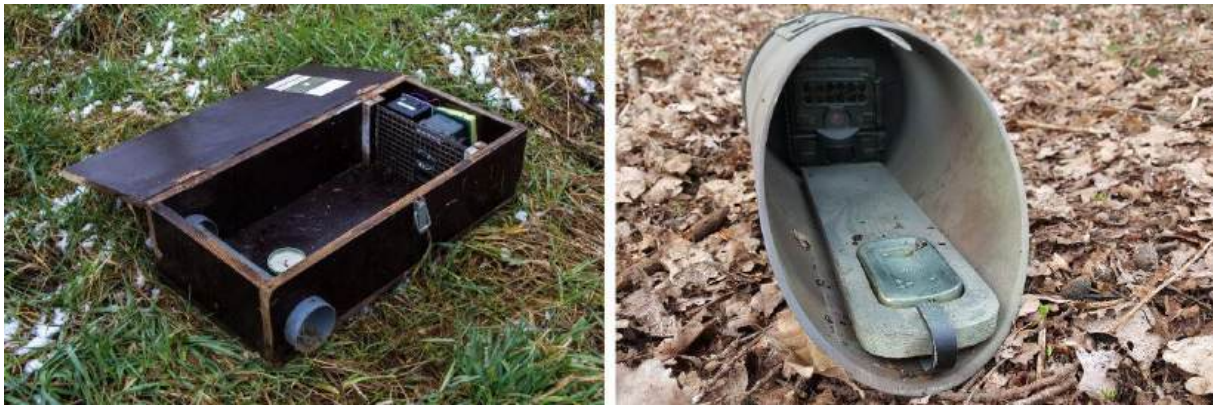
Figuur 4. Mostela (links) en Struikrover (rechts) zijn beide aangepaste wildcamera's voor het registreren van kleine zoogdieren
