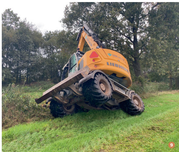
9 Gekantelde kraan door oeverholen van bever. (Foto: Waterschap Aa en Maas)
