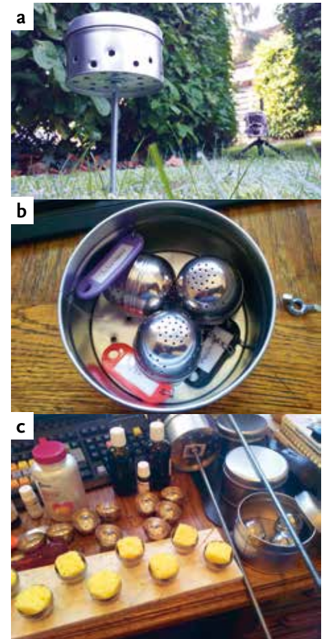
Foto 3 a, b en c. Het geurstation bestond uit een geperforeerd blikje (a) met daarin drie thee-eieren (b) met lokstoffen op een spons (c): valerianaolie, zalmolie en pinda-kaas. (Foto's: Sil Westra)
