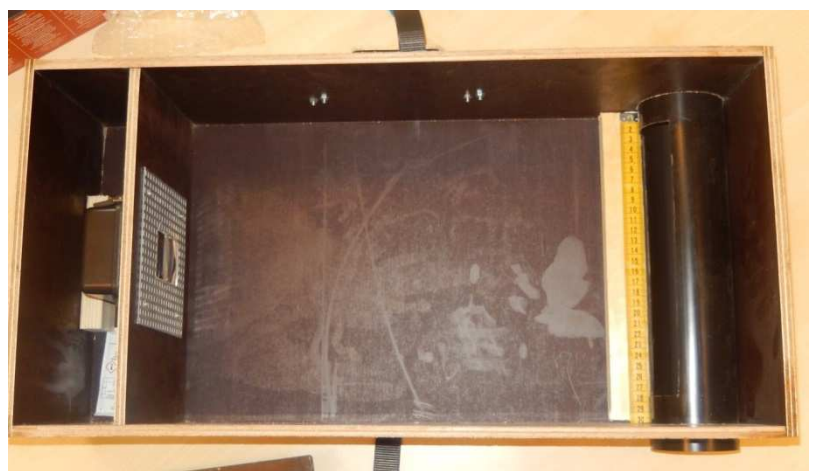
Figuur 10: Een marterbox van bovenaf gefotografeerd. Links bevindt zich de wildcamera, rechts de loopbuis waar de kleine marters doorheen lopen (ontwerp en foto M. Smaal).
